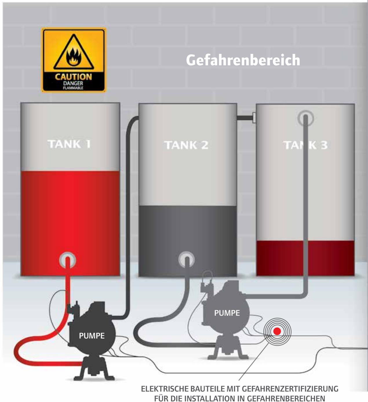
ARO® EXP-Pumpen mit elektronischer Schnittstelle sind ideal für das Pumpen von Flüssigkeiten wie Lösungsmitteln, Ethanol oder Kraftstoffen und anderer potenziell entflammbarer Medien in Umgebungen mit hoher chemischer Konzentration, wie z. B. der chemischen Verarbeitung, der Lackiererei/Endbearbeitung, dem Energie-, Ethanol, Öl-, Gas- und Kraftstofftransfer, sowie in Onshore- und petrochemischen Anlagen.
